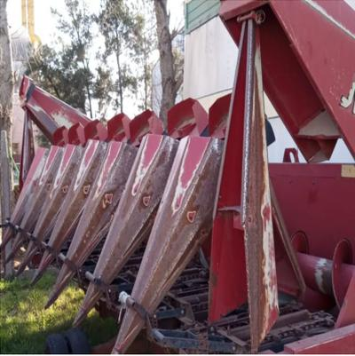
Cabezal maicero Usado – 8 surcos a 70cm – Embocador John Deere 1185 – INT 462
